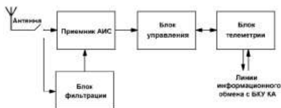
Рис. 2. Блок-схема ПН (БКУ – бортовой комплекс управления)
